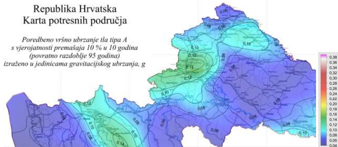
Slika 5: Izvod iz Karte potresnih područja u RH; Poredbeno vršno ubrzanje tla tipa A, povratno razdoblje 95 godina
